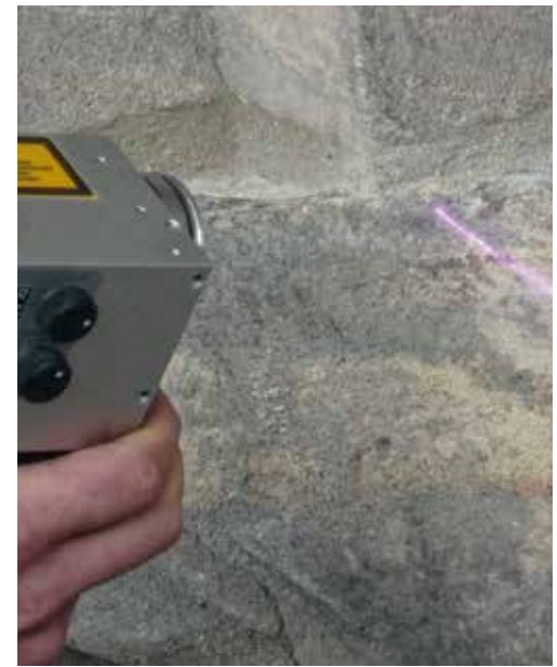
Reinigung einer Steinoberfläche mit einem Laser, Fotos: Mathias König
